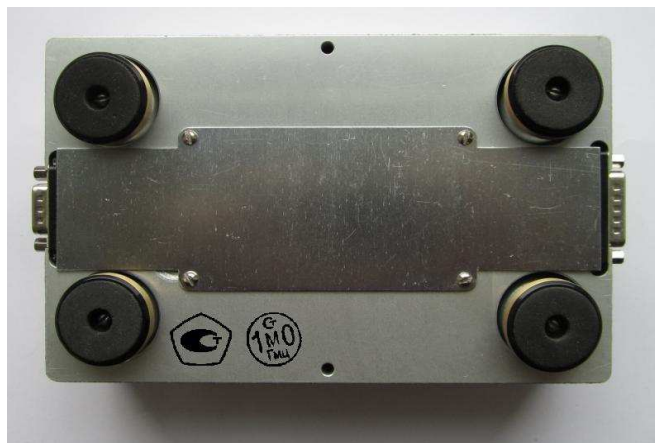
Рисунок 2 - Микроскоп сканирующий зондовый «СММ-2000», измерительная головка, вид снизу; указаны места нанесения знака утверждения типа и поверительного клейма
